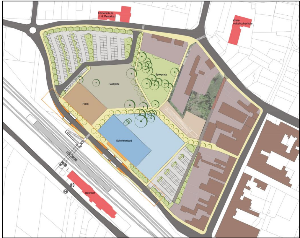
7. Stufe: Bau des nördlichen Parkraumangebots inkl. Erschließungsstraße
