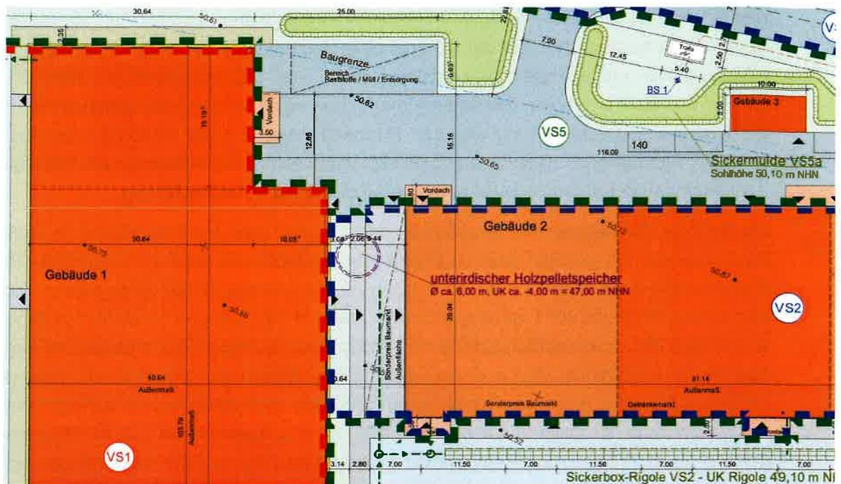
Abbildung 5-6: Lage des unterirdischen Holzpellettspeichers
